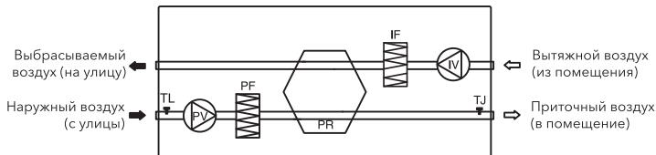
PV – вентилятор приточного воздуха;
