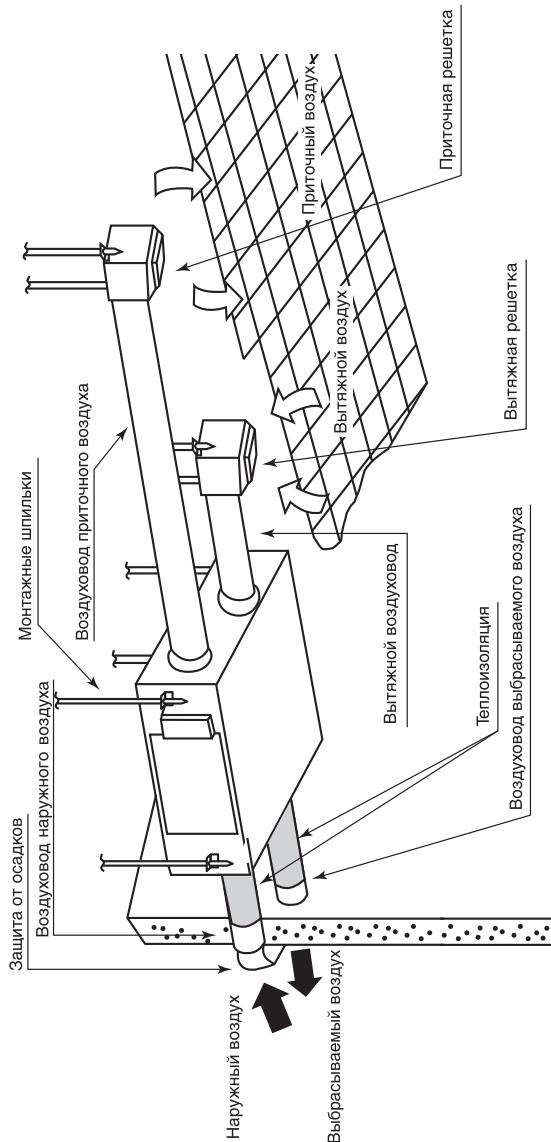
Воздуховоды наружного и выбрасываемого воздуха должны быть теплоизолированы.
