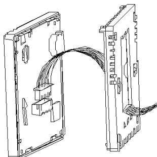
4. Вставьте крышку в корпус под углом 30° и закройте ее
